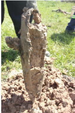
LIMO CON CIERTO GRADO DE LITIFICACION. TIPO "TOSCA". TIPICO DE FORMACION FRAY BENTOS
