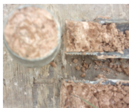
LIMO CON CIERTO GRADO DE LITIFICACION. TIPO "TOSCA". TIPICO DE FORMACION FRAY BENTOS
