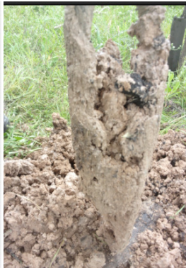
LIMO CON CIERTO GRADO DE LITIFICACION. TIPO "TOSCA". TIPICO DE FORMACION FRAY BENTOS
