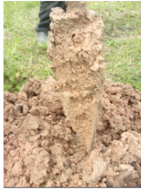
LIMO CON CIERTO GRADO DE LITIFICACION. TIPO "TOSCA". TIPICO DE FORMACION FRAY BENTOS
