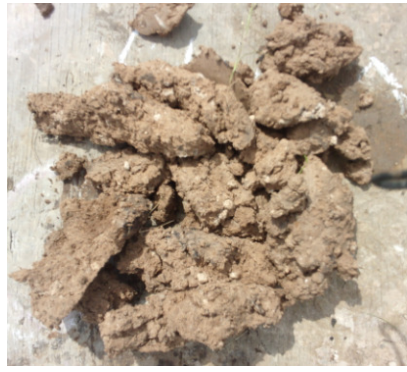
LIMO ARCILLOSO COLOR MARRON A ROSADO, HUEMDAD ALTA. CONSISTENCIA BLANDA
