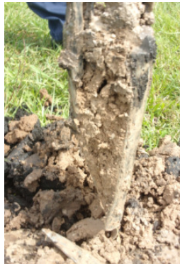
LIMO ARCILLOSO COLOR MARRON A ROSADO, HUEMDAD ALTA. CONSISTENCIA BLANDA
