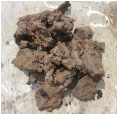
LIMO ARCILLOSO COLOR MARRON A ROSADO, HUEMDAD ALTA. CONSISTENCIA BLANDA
