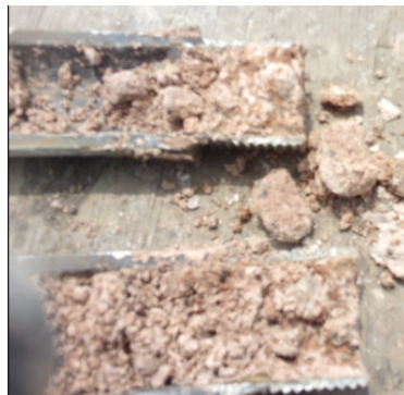
LIMO CON CIERTO GRADO DE LITIFICACION. TIPO "TOSCA". TIPICO DE FORMACION FRAY BENTOS
