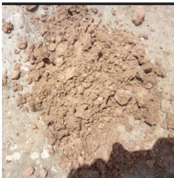
LIMO CON CIERTO GRADO DE LITIFICACION. TIPO "TOSCA". TIPICO DE FORMACION FRAY BENTOS
